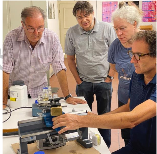
Schneiden am Jung HN-40 Schlittenmikrotom.
