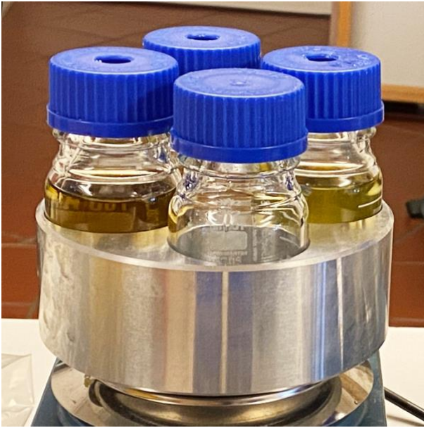
Flaschen mit PEG-Lösungen am Laborofen im Aluaufsatz, der für eine gleichmäßige Temperaturverteilung sorgt, damit eine geringere Höchsttemperatur benötigt und dadurch gewebeschonender ist.
