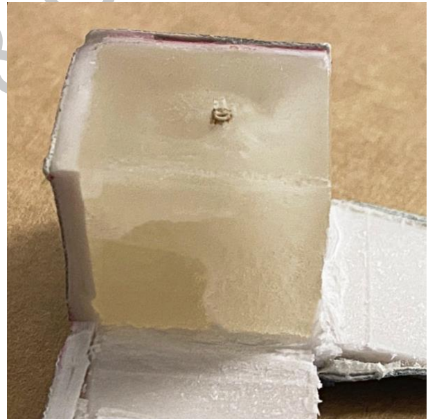
Mit PEG gefülltes Förmchen nach dem Aushärten und vor dem Schneiden.
