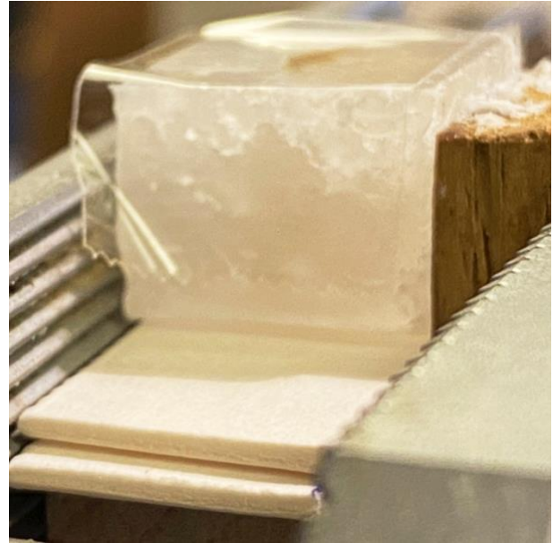
Zusätzlich wird das Blöcken von unten mit Holz unterstützt (symmetrische Backenposition) und in der Höhe mit Kartonstreifen feinjustiert.
