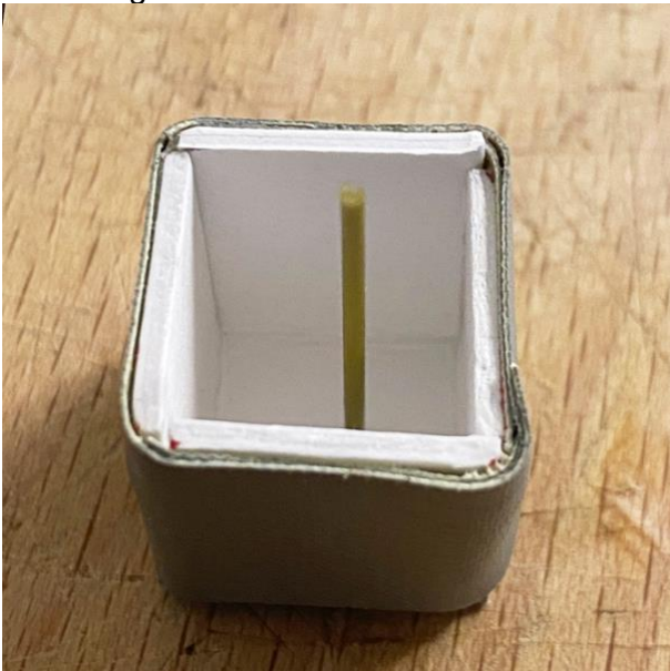
Ausgerichtetes Schnittgut, das am Grund mit wenig PEG fixiert ist.
