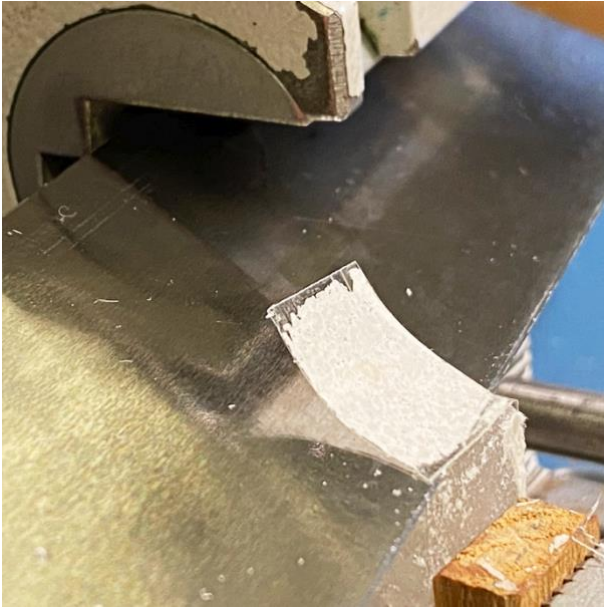
Der Schnitt mit dem Tixo am Mikrotom-Messer (ziehender Schnitt).
